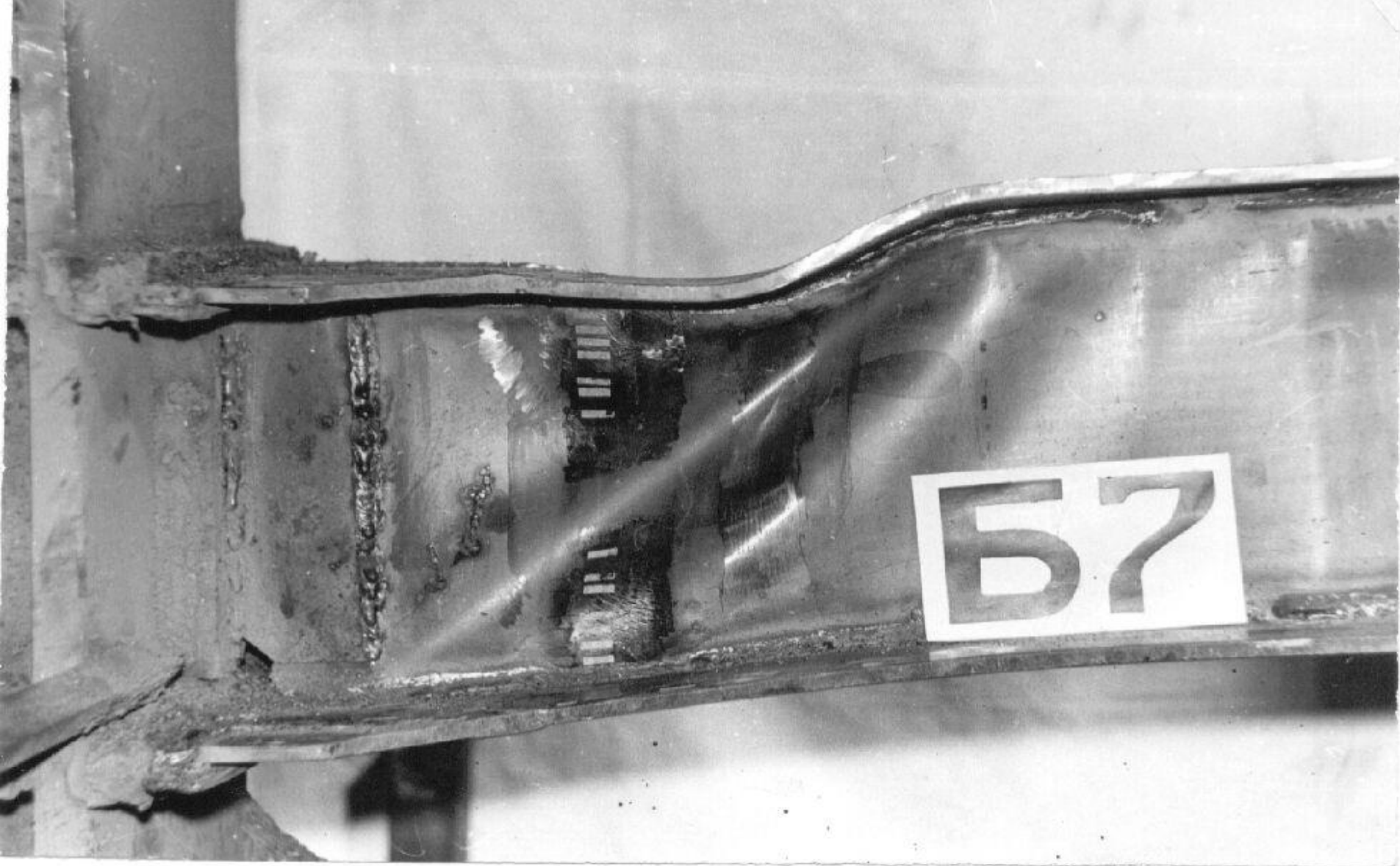
Характер разрушение гофрированной стенки при одностороннем однократном нагружении при гофрах с незначительной высотой волны
