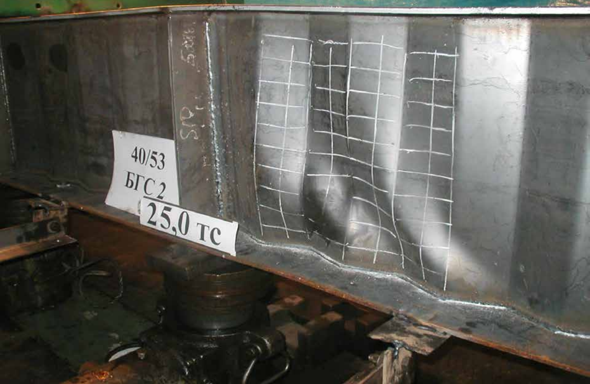
Испытание сварных двутавровых профилей из сортамента. Общая потеря устойчивости гофрированной стенки
