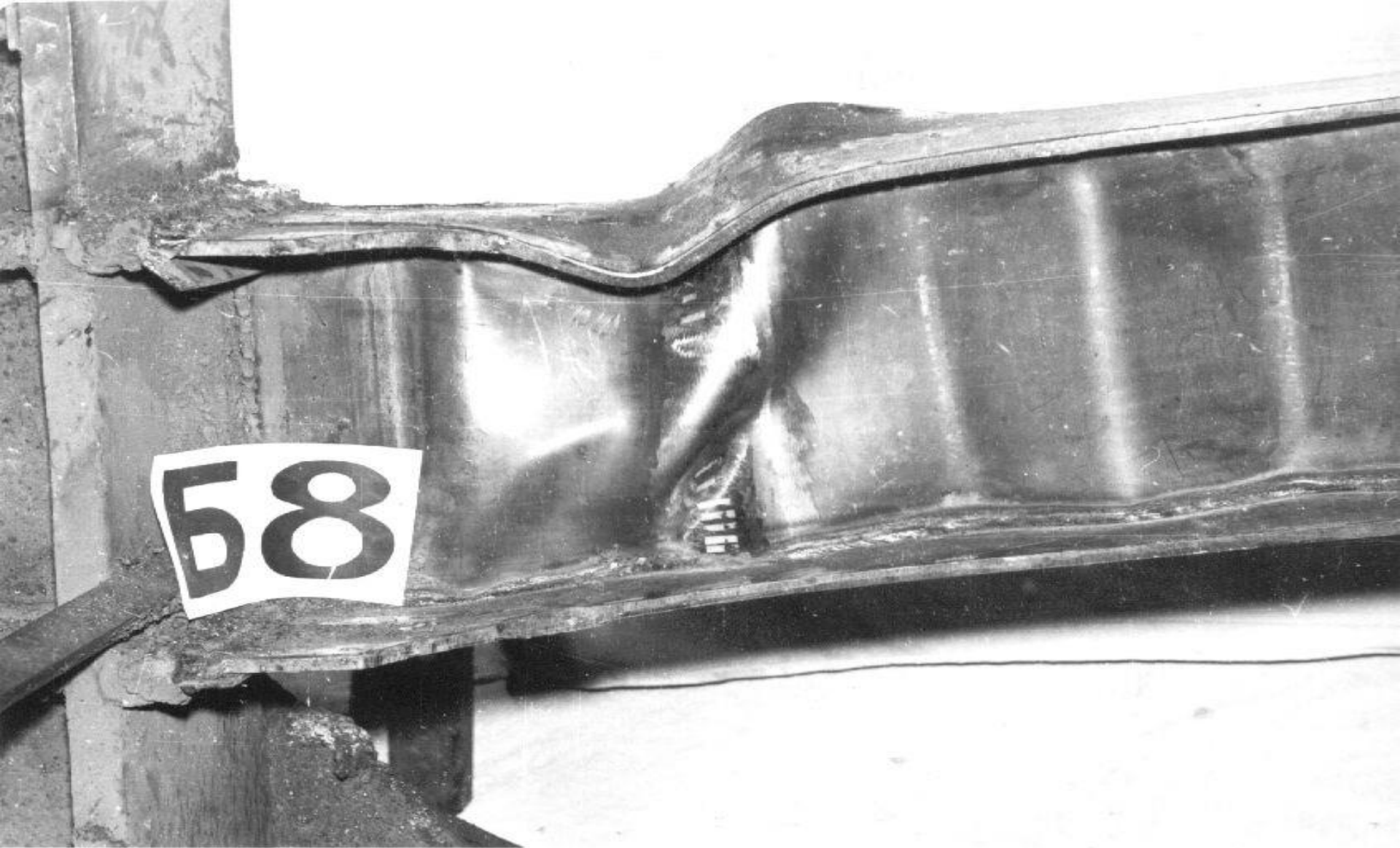
Характер разрушение гофрированной стенки при одностороннем однократном нагружении при гофрах со значительной высотой волны
