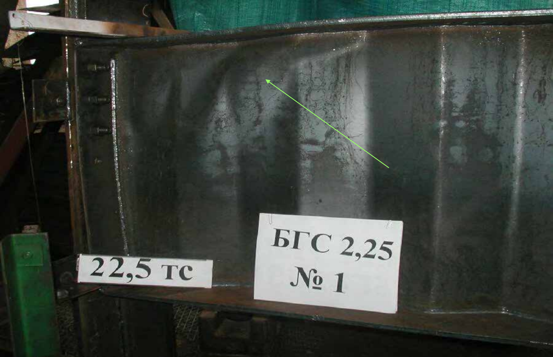
Потеря общей устойчивости гофрированной стенки
