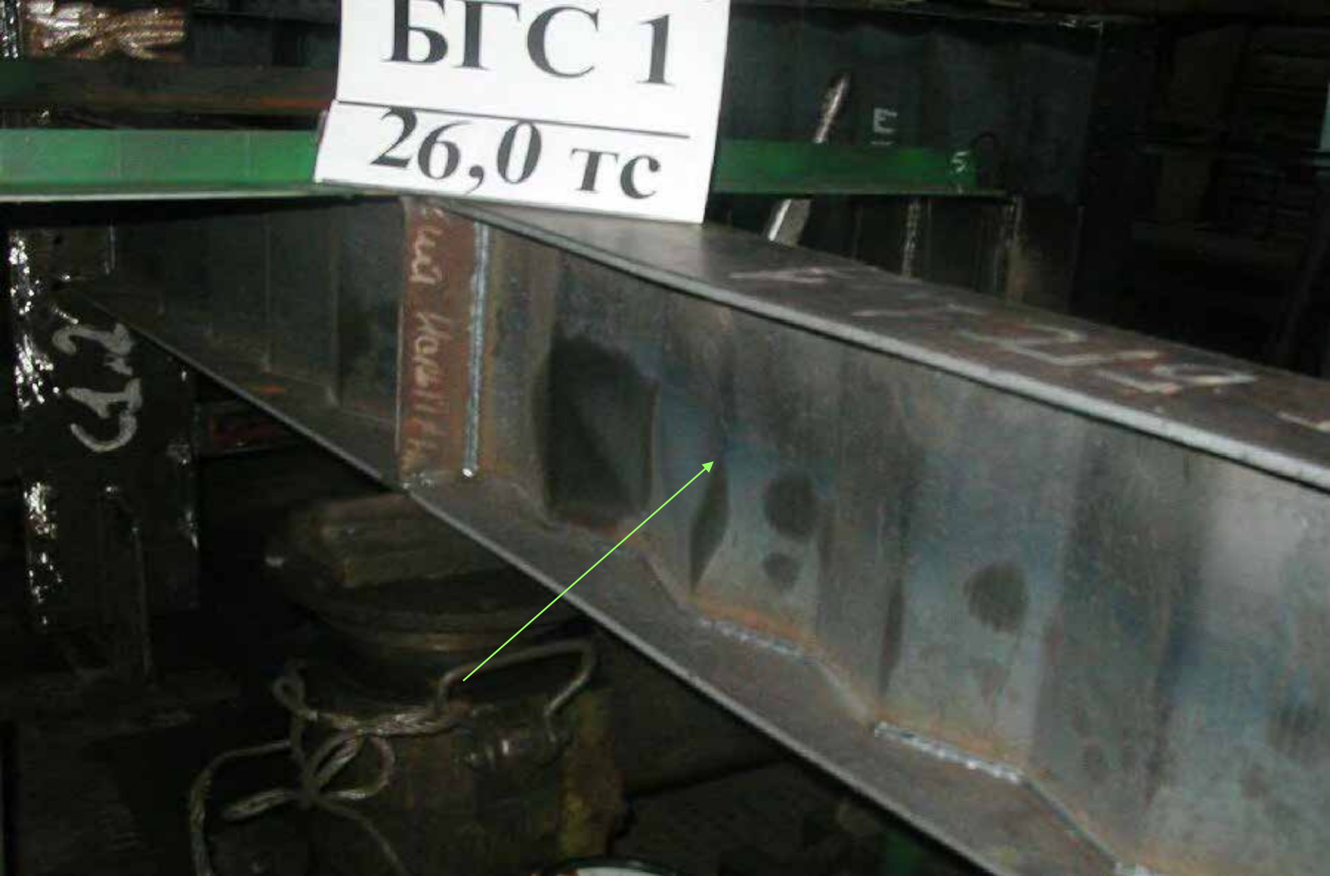
Потеря общей устойчивости гофрированной стенки
