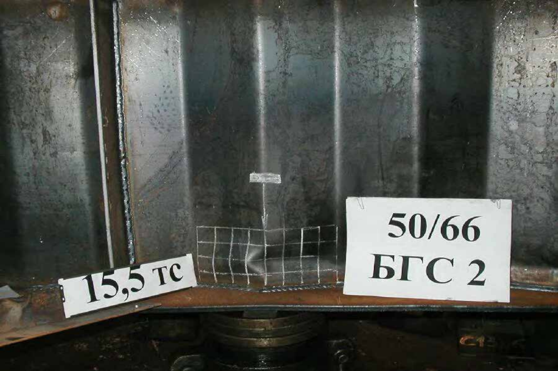
Потеря локальной устойчивости под сосредоточенным грузом гофрированной стенки
